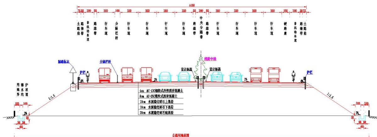
图 2.2-9 路基标准横断面（路基宽度 44.5 米）
