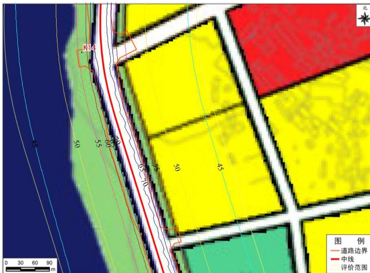
图 5.2-29 牛肚山~大广高速大冶互通段（大冶城区规划区）远期夜间等声级线图
