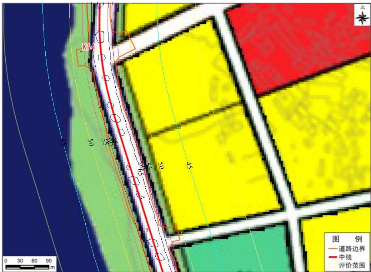
图 5.2-25 牛肚山~大广高速大冶互通段（大冶城区规划区）近期夜间等声级线图
