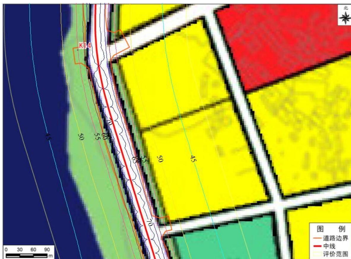
图 5.2-27 牛肚山~大广高速大冶互通段（大冶城区规划区）中期夜间等声级线图
