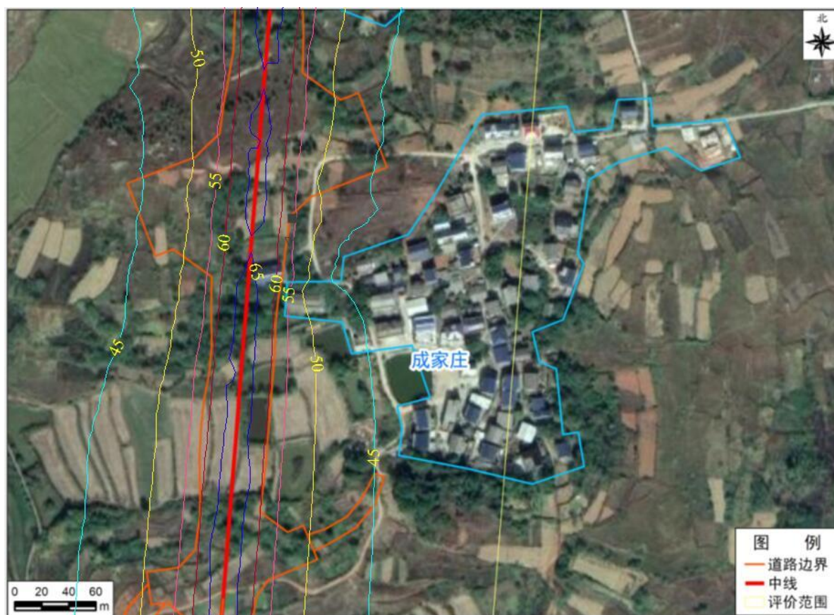
图 5.2-19 牛肚山~大广高速大冶互通段（成家庄）近期夜间等声级线图
