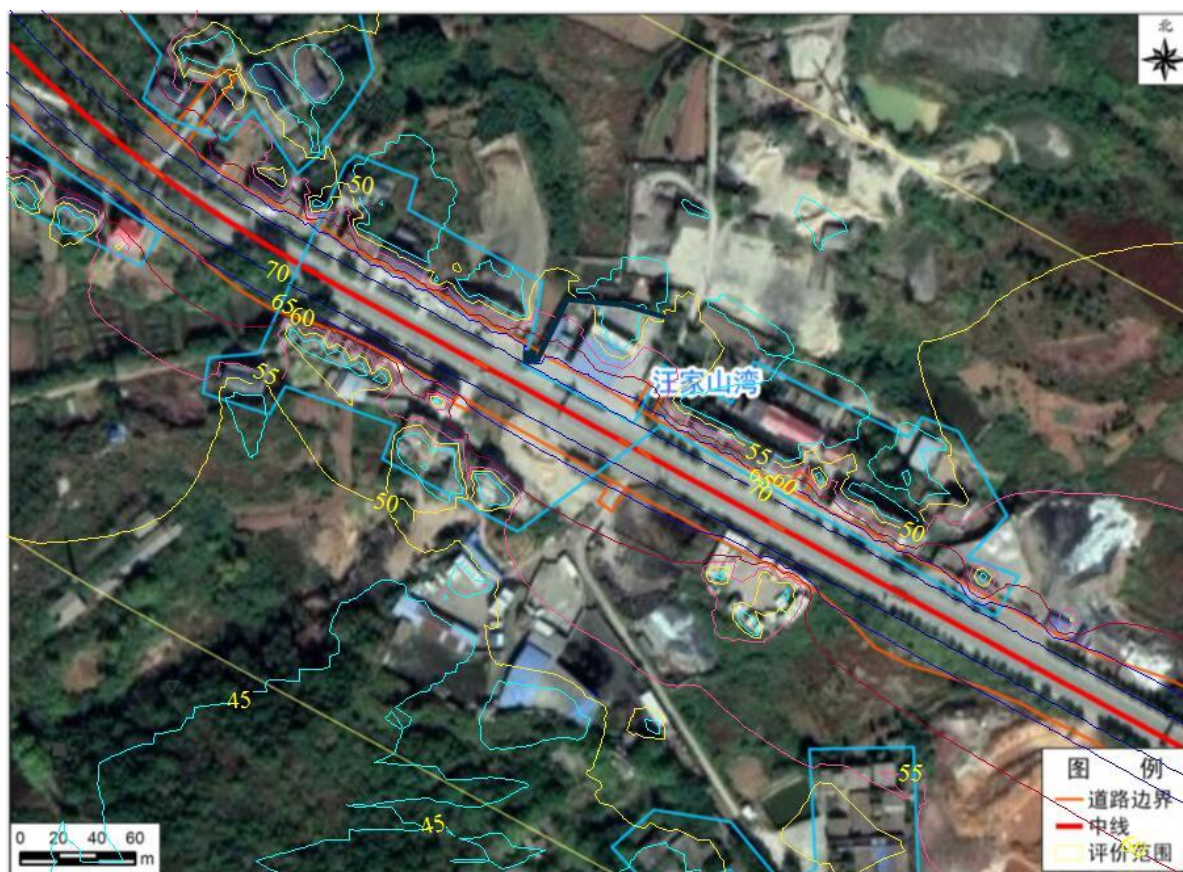
图 5.2-32 牛肚山~大广高速大冶互通段（汪家山湾）中期昼间等声级线图
