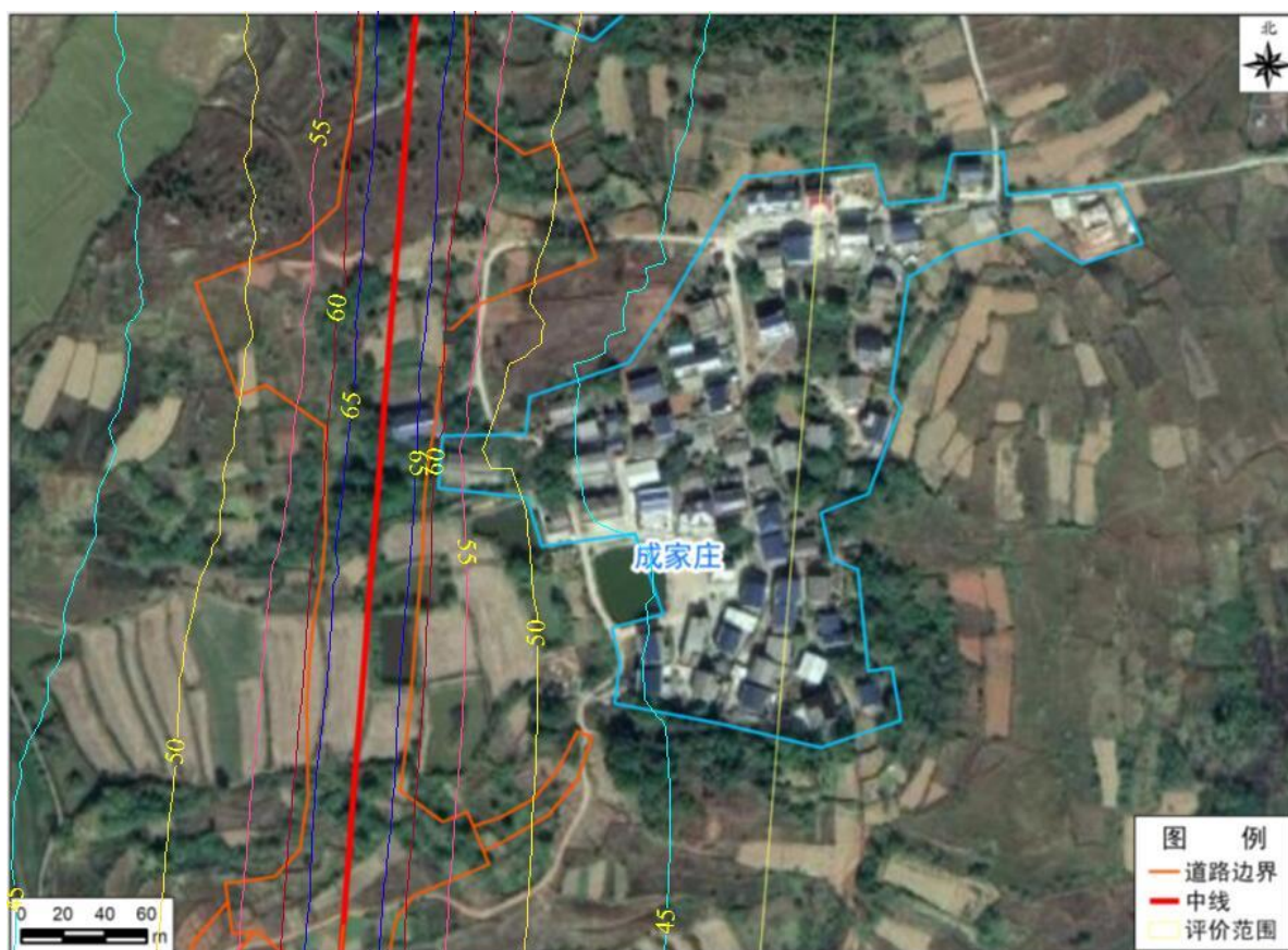
图 5.2-23 牛肚山~大广高速大冶互通段（成家庄）远期夜间等声级线图
